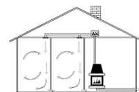
Tlačný ventilátor v podkrovi
